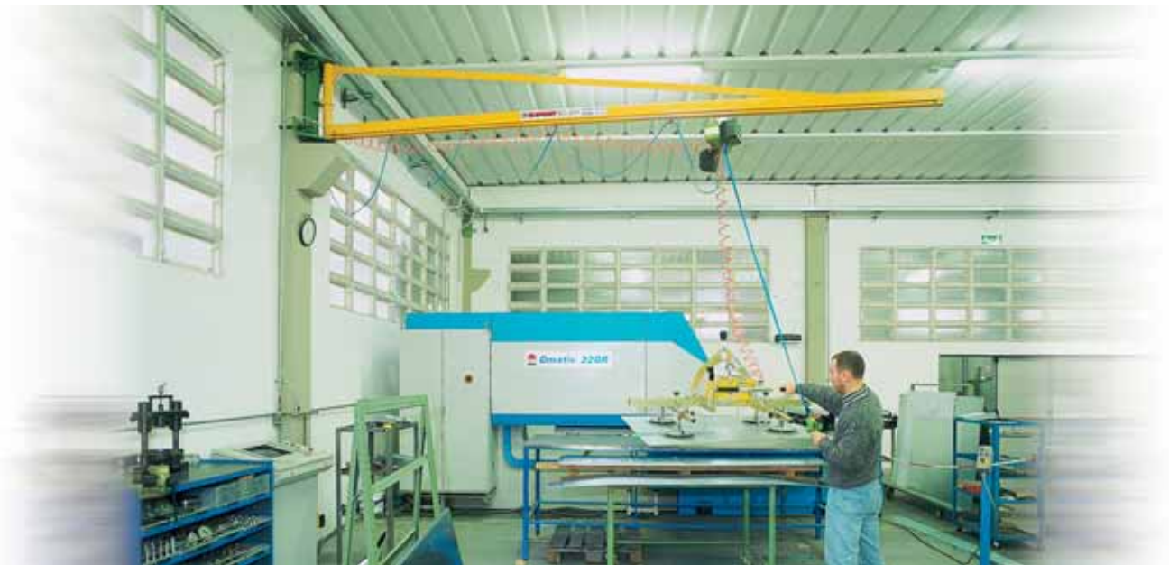
Gru a bandiera a mensola con braccio profilato in canalina. Jib crane, bracket-mounted with channel-type structural steel arm. Potence murale avec flèche en profilé creux à glissière. Konsol-Auslegerkran mit Führungskanal-Profilarm.
