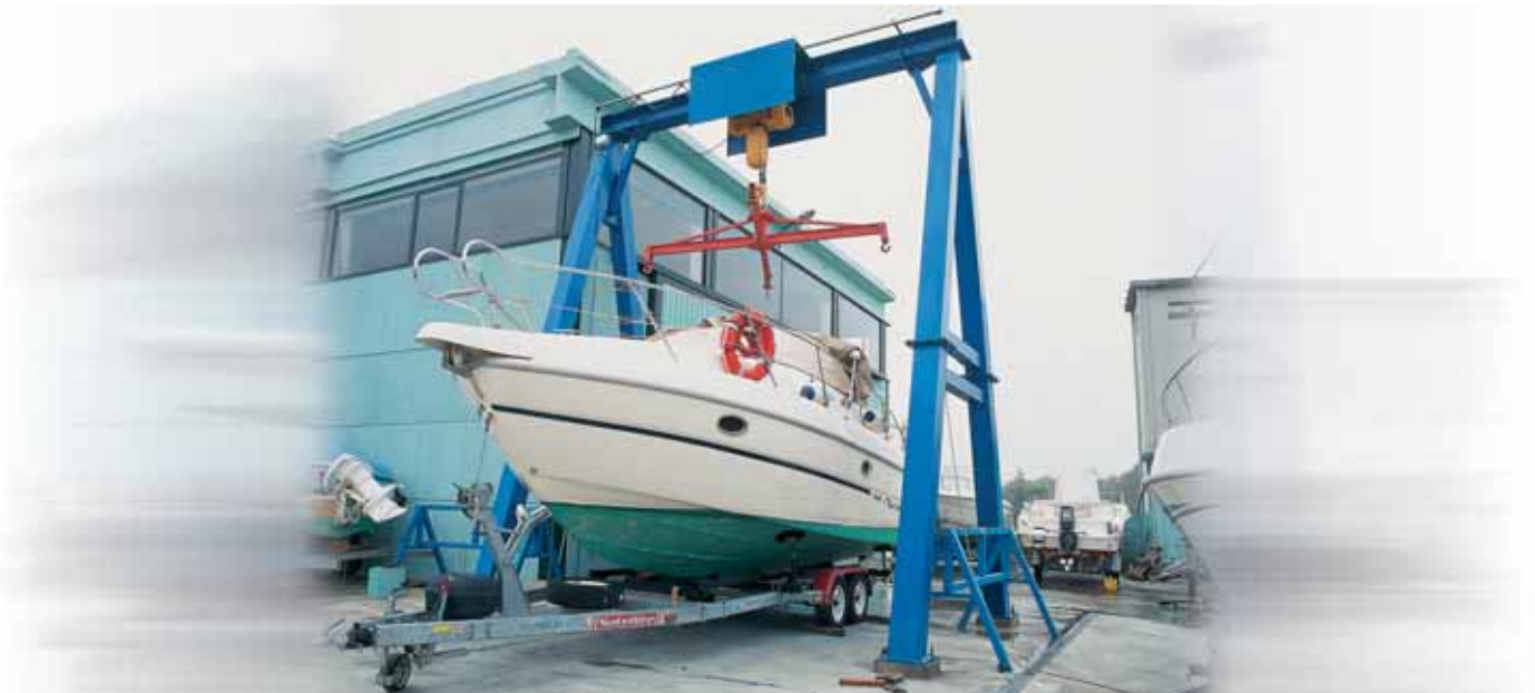
Gru a portale. Gantry crane. Grue à portique. Portalkran.
