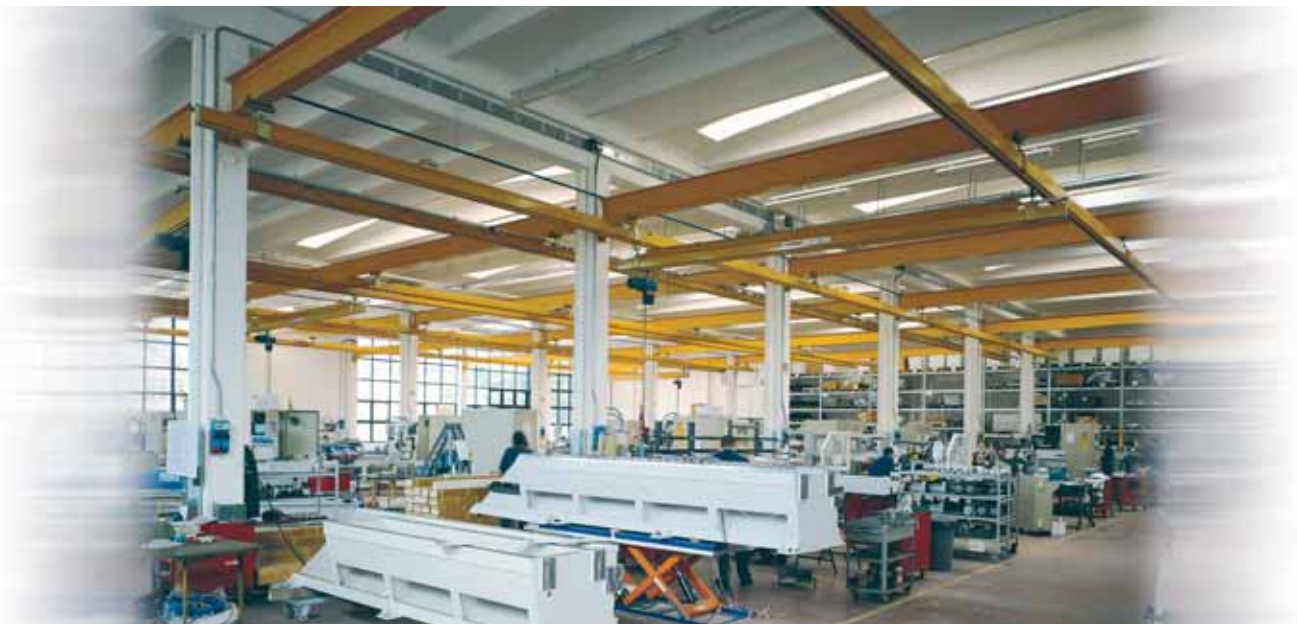
Impianti sospesi in canalina con traslazione manuale. Suspended channel systems with manual translation. Appareils suspendus en profilé creux à glissière avec translation manuelle. Hängeanlagen mit Führungskanal und manueller Versetzung.
