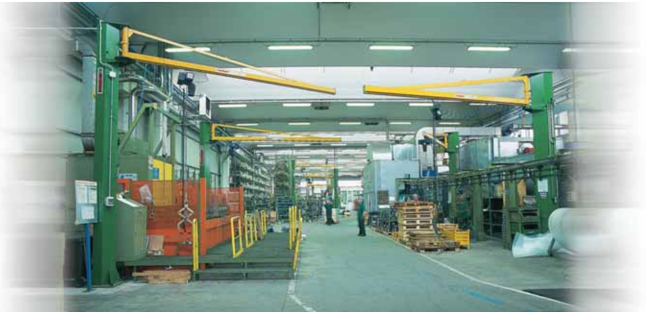
Gru a bandiera a colonna con braccio profilato in canalina. Column-mounted jib crane with channel-type structural steel arm. Potence à colonne avec flèche en profilé creux à glissière. Säulen-Auslegerkran mit Führungskanal-Profilarm.
