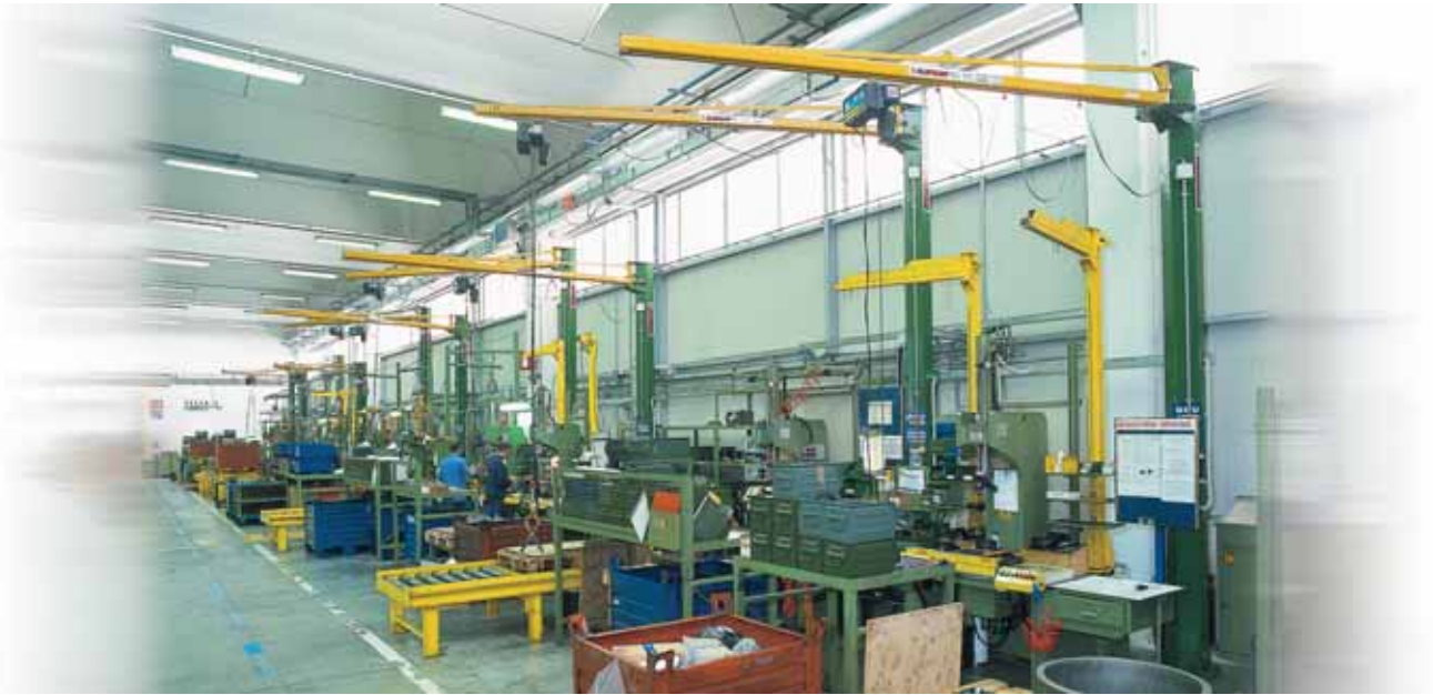
Gru a bandiera a colonna con braccio profilato in canalina. Column-mounted jib crane with channel-type structural steel arm. Potence à colonne avec flèche en profilé creux à glissière. Säulen-Auslegerkran mit Führungskanal-Profilarm.
