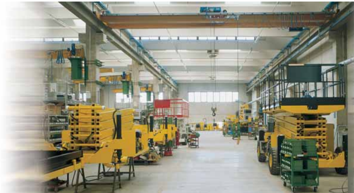
Carroponte bitrave. Double-girder bridge crane. Pont roulant à deux poutres. Laufbrücke mit zwei Trägern.
