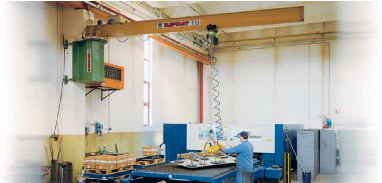
Gru a bandiera a rotazione elettrica a 360° con ventosa. Jib crane with 360° power rotation with vacuum grab. Potence à rotation électrique à 360° avec palonnier. Auslegerkran mit elektrischer Rotation um 360° und Saugnapf.
