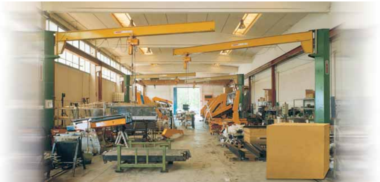
Gru a bandiera a colonna con braccio in trave a sbalzo. Column-mounted jib crane with cantilever jib. Potence à colonne avec flèche à poutre en encorbellement. Säulen-Auslegerkran mit Kragträgerarm.
