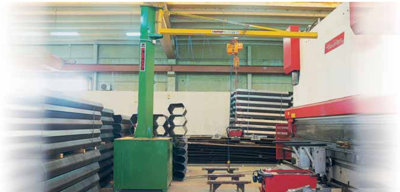
Gru a bandiera a colonna con basamento pallettizzato. Column-mounted jib crane with palletized base. Potence à colonne avec empattement palettisé. Säulen-Auslegerkran mit Paletten-Untergestell.
